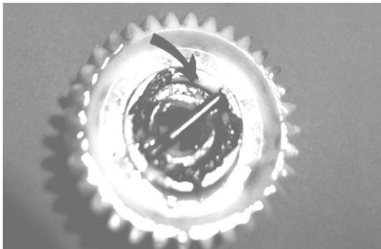
Bild 277.: Defektes Wasserpumpenantriebsrad
