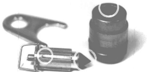
Bild 274.: Verschlissene Nadelventile
